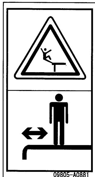
Знак указывает на опасность падения с ограждающего щитка или капота.
